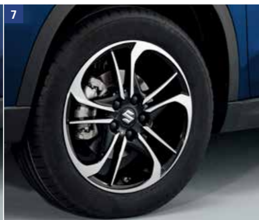
7 | Ráfek z lehké slitiny „MOJAVE“ WVTA Černý lesklý, 6,5 J x 17", vhodný pro pneumatiky 215/55 R17, včetně středové krytky s logem S. Objednací číslo 43210-54PU1-0SP A D
