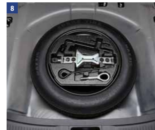
8 | Sada rezervního kola WVTA 48V Obsahuje pneumatiku, ventil, kolo, držák, informační leták, schránku s nářadím a zvedák. Objednací číslo 9929P-63T01-000 C D E K L M
